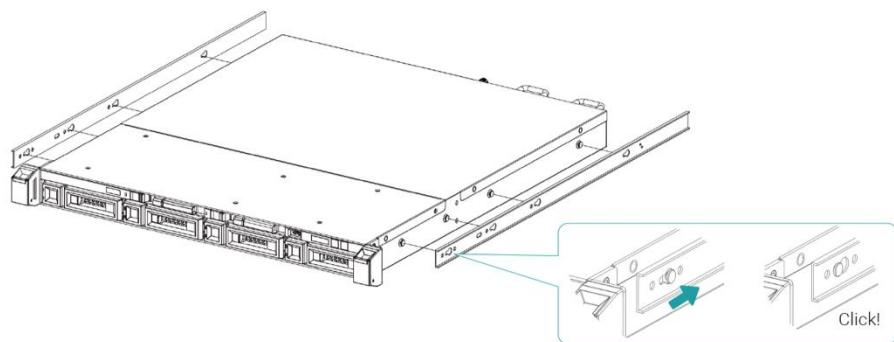
3. 將滑軌前端插入機架，並固定後端彈簧片。重複步驟直到安裝完左側及右側滑軌。
