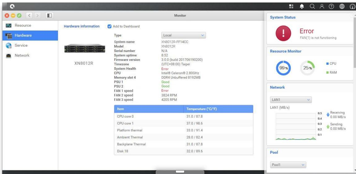
若您看到上述所顯示的訊息，代表您需要立即更換風扇模組，請參考[章節 3.4 更換系統風扇](#)進行相關操作。當風扇更換完成後，您可以在 QSM 上面看到該風扇每分鐘的轉速(RPM)資訊。
